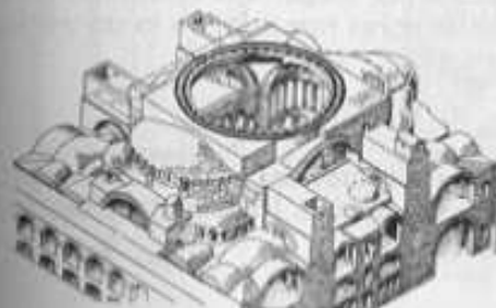
Construcción de la bóveda (Santa Sofía)
